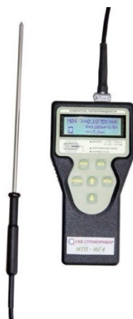
Рис. 5. Измеритель теплопроводности «ИТП-МГ4 ЗОНД»
